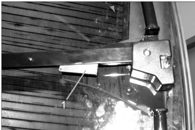
1 Odjištění dveří uvnitř
