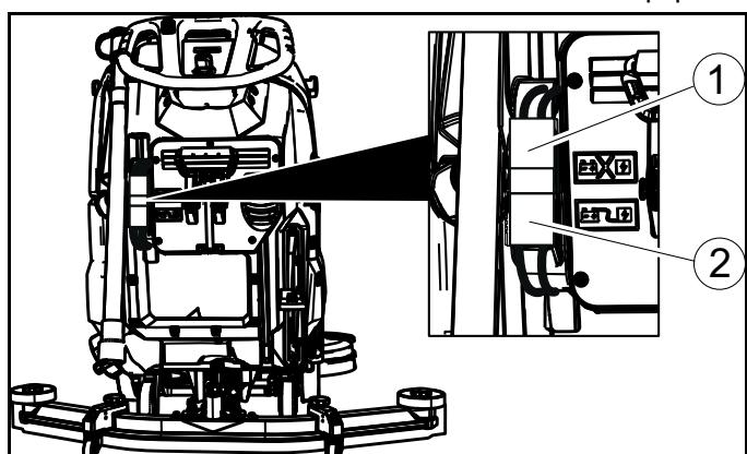
① Conector de la batería, lado del equipo
