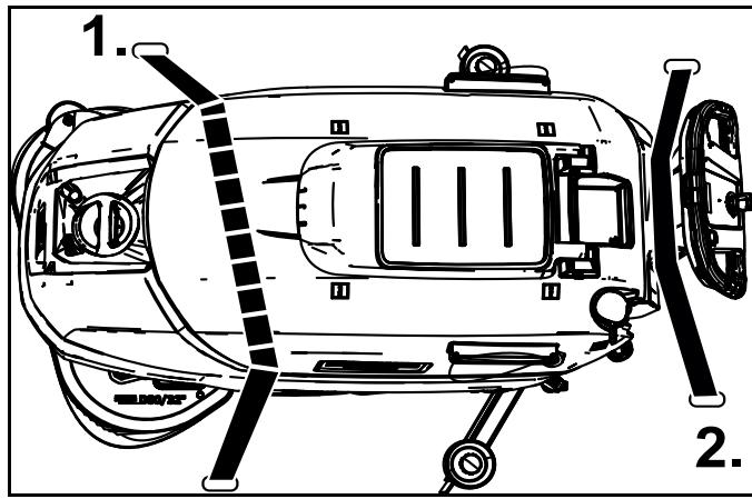
7. Colocar en primer lugar la correa de sujeción bajo el depósito de agua sucia.
