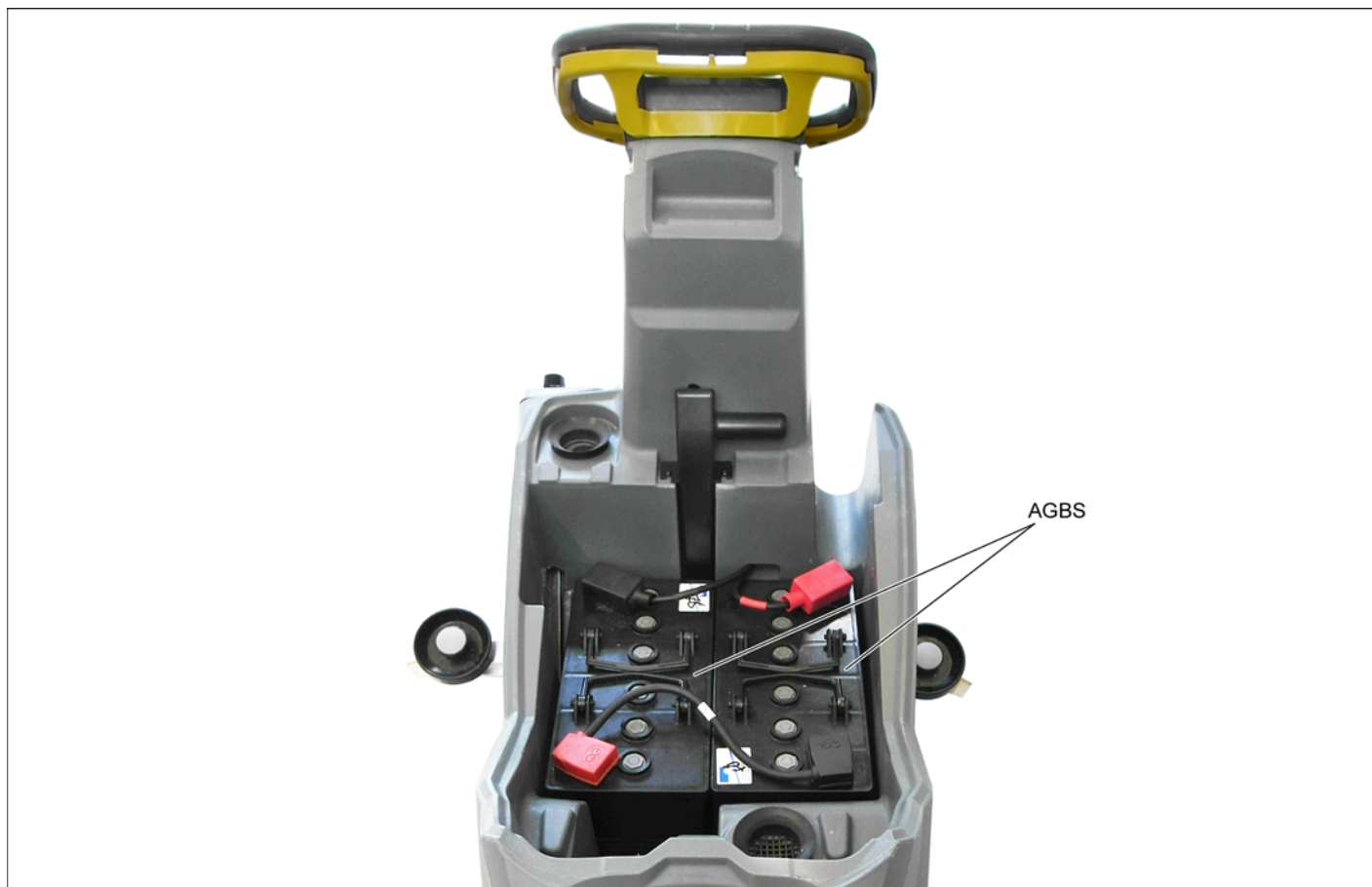
AGBS Monter/démonter les batteries
