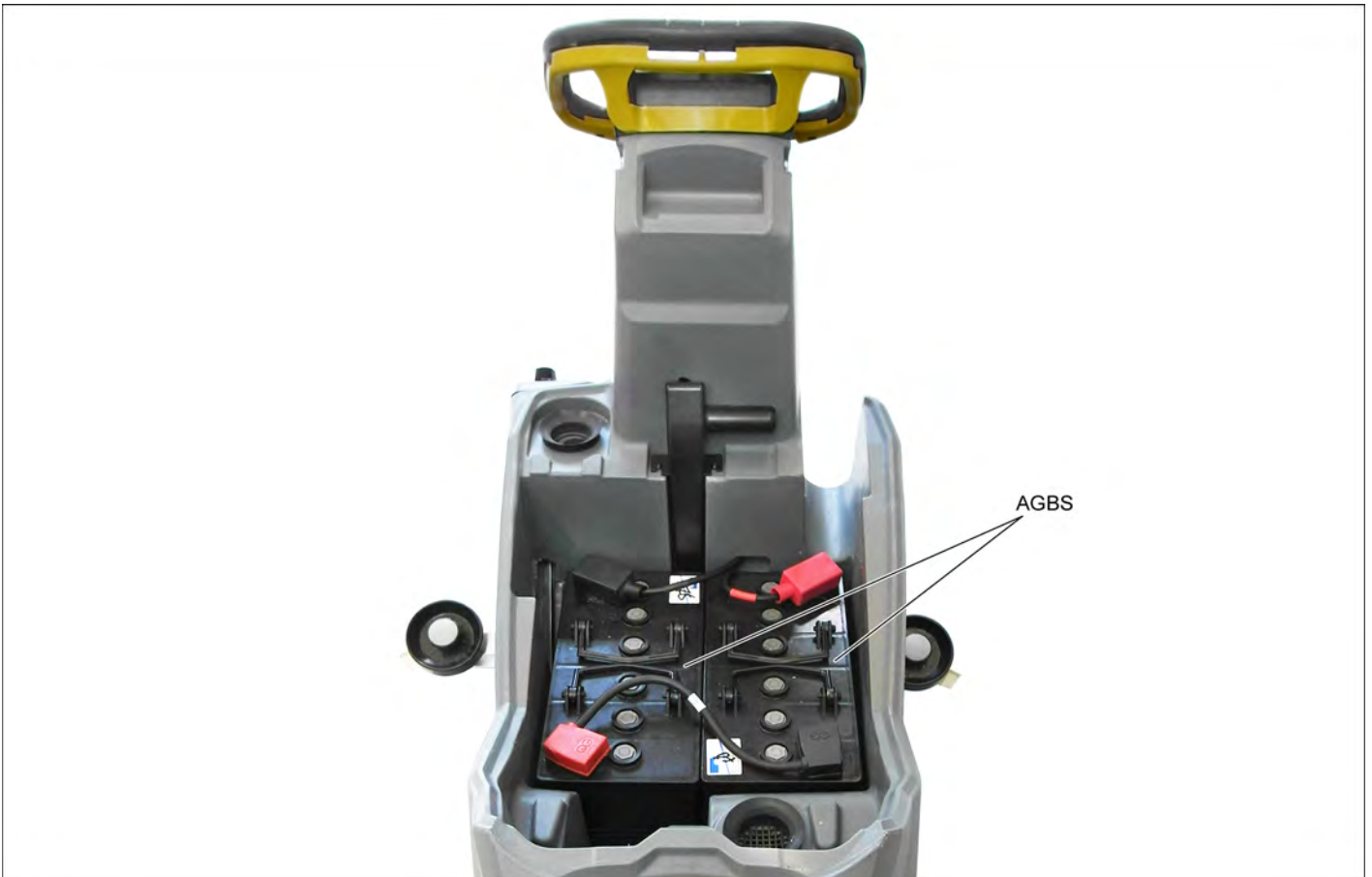
AGBS Desmontar/montar las baterías
