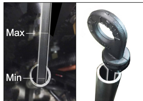
Slika: Merjenje nivoja olja v bencinskem motorju (KM 105/... in KM 125/...)
