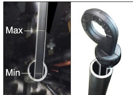
Obrázok: Meranie výšky hladiny oleja v benzínovom motore (KM 105/... a KM 125/...)
