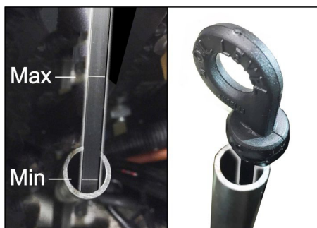
Imagine: Măsurarea nivelului de ulei în motorul pe benzină (KM 105/... și KM 125/...)
