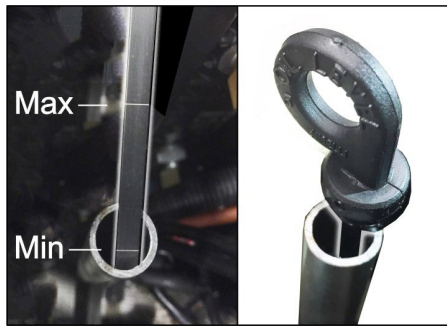
Рисунок: измерение уровня масла в бензиновом двигателе (KM 105/... und KM 125/...)
