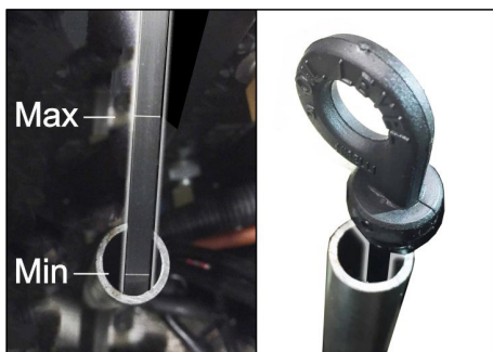
Фигура: Измерване на нивото на маслото при бензинов двигател (KM 105/... и KM 125/...)
