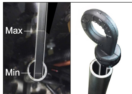
obr.: Měření hladiny oleje v benzinových motorech (KM 105/... a KM 125/...)
