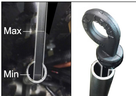
Joonis: Õlitaseme mõõtmine bensiinimootori korral (KM 105/... ja KM 125/...)
