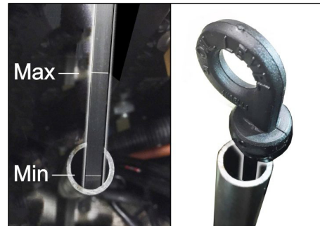
Slika: Mjerenje razine ulja u benzinskim motorima (KM 105/... i KM 125/...)
