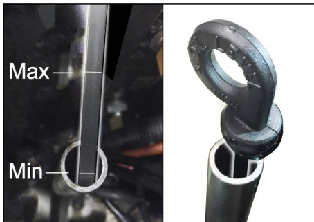
Pav.: Alyvos lygio matavimas benzininiame variklyje (KM 105/... ir KM 125/...)
