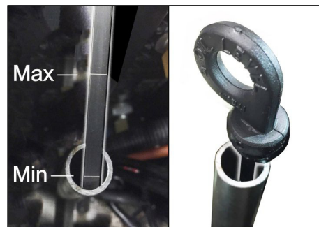
Attēls: eļļas līmeņa mēršana benzīna dzinējā (KM 105/... un KM 125/...)
