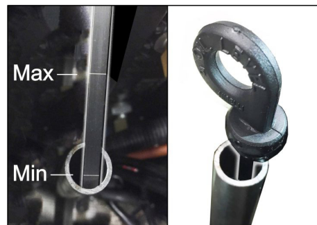
Slika: Merenje nivoa ulja benzinskog motora (KM 105/... i KM 125/...)
