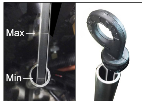
Figure : Mesurer le niveau d'huile du moteur thermique (KM 105/... et KM 125/...)
