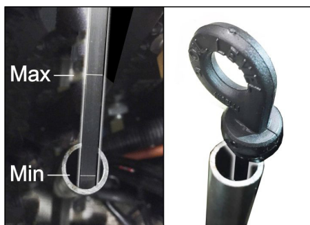
Afbeelding: Oliepeil in de benzinemotor meten (KM 105/... en KM 125/...)
