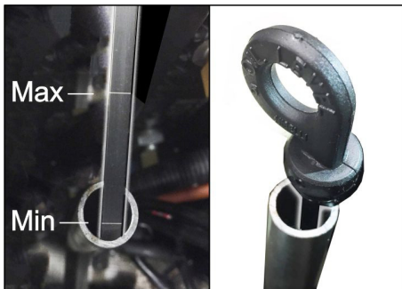
Kuva: Bensiniinimoottorin öljymäärän mittaminen (KM 105/... ja KM 125/...)
