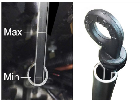
Figur: Måling af benzinmotorens olieniveau (KM 105/... og KM 125/...)
