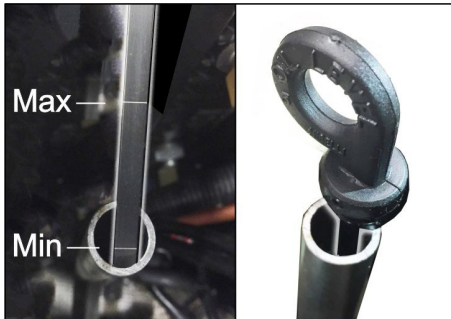
Bild: Mät bensinmotorns oljenivå (KM 105/... och KM 125/...)
