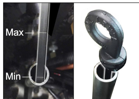
Figura: medición del nivel de aceite en el motor de gasolina (KM 105/... y KM 125/...)
