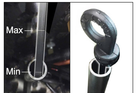
Abbildung: Ölstand messen beim Benzinmotor (KM 105/... und KM 125/...)
