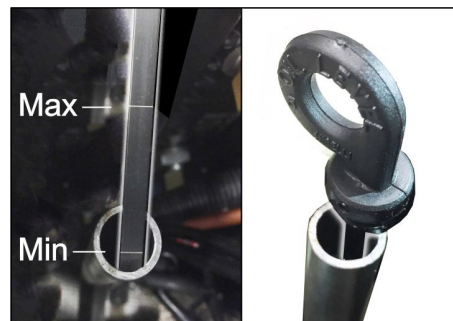
Figura: Medição do nível do óleo no motor a gasolina (KM 105/... e KM 125/...)
