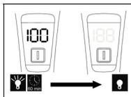
Depois de a bateria estar completamente carregada, a indicação LED acende durante 60 minutos e depois apaga
