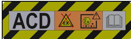
Laite soveltuu tulenarkojen pölyjen imuointiin, asennus vyöhykkeen 22 ulkopuolelle.
