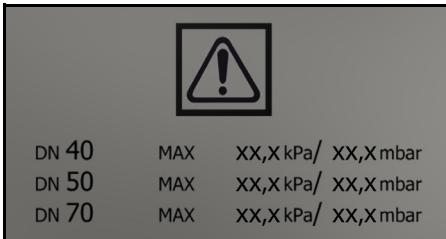
Der Aufkleber zeigt die Werte für den max. Unterdruck in Relation zum verwendeten Saugschlauchquerschnitt. Der aktuelle Wert kann am Manometer abgelesen werden. Die für dieses Gerät geltenden Werte siehe Kapitel *Mindestvolumenstrom ablesen*. Wird der Wert unterschritten, muss der
