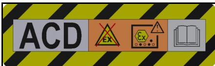
Das Gerät ist zum Saugen von brennbaren Stäuben, Aufstellung außerhalb Zone 22 geeignet.
