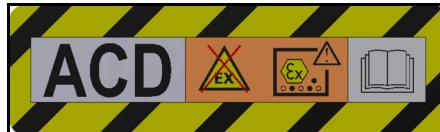
Apparatet er beregnet til opsugning af brandbart støv, opstilling uden for zone 22.
