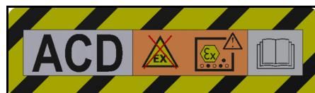
Urządzenie jest przystosowane do odkraczania pyłów palnych, instalacja poza strefą 22.
