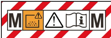
الجهاز مناسب لشفط الغبار حتى فئة الغبار M.
