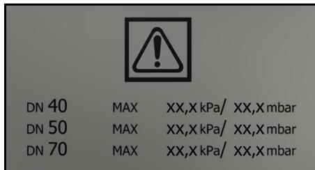
Жапсырма парағы пайдаланылған сору шлангінің көлденен қымасына арналған максималды төмен қысымның мәндерін көрсетеді. Ағымдағы мәнді манометрден оқуға болады. Осы құрылғыға қолданылатын мәндерді Ең аз көлем шығының оқыңыз тарауынан қаралып. Егер мән осы мәннен төмен түссе, сүзгіні тазалау ( Сүзгіні тазалау тарауын қаралып) немесе ауыстыру керек ( Сүзгіні ауыстырыңыз тарауын қаралып). Сору шлангісінің әртүрлі қымалары керек-жарақтардың әртүрлі қосылым қымаларына бейімделуіне мүмкіндік береді.
