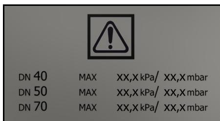
Tarra osoittaa maks. alipaineen arvot suhteessa käytettyyn imuletkun läpimittaan. Nykyisen arvon voi lukea painemittarista. Tätä laitetta koskevat arvot, ks. luku **Vähimmäistilavuusvirran tarkistaminen**. Jos arvo alittuu, suodatin pitää puhdistaa (ks. luku *Suodattimen puhdistaminen*) tai vaihtaa (ks. luku *Suodattimen vaihto uuteen*). Imuletkun eri läpimitat mahdollistavat sovitamisen varusteosien liittimien eri läpimittoihin.
