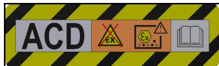
Apparatet er egnet for suging av brennbart støv, installasjon utenfor sone 22.
