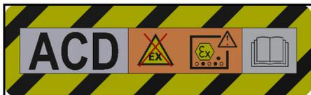
Urządzenie jest przystosowane do odkurzania pyłów palnych, instalacja poza strefą 22.
