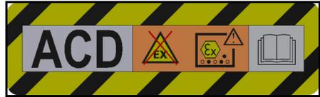
Laite soveltuu tulenarkojen pölyjen imurointiin, asennus vyöhykkeen 22 ulkopuolelle.
