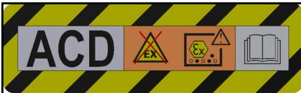
Naprava je primerna za sesanje vnetljivega prahu, postavitve izven cone 22.
