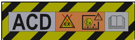
Apparatet er beregnet til opslugning af brandbart støv, opstilling uden for zone 22.
