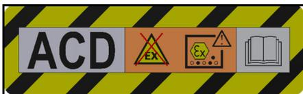
Apparatet er egnet for suging av brennbart støv, installasjon utenfor sone 22.
