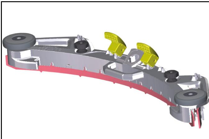
Den Saugbalken demontieren und grobe Verschmutzungen entfernen. Anschließend mit Wasser abspülen. Überprüfen Sie auch die Sauglippen auf Beschädigungen und drehen oder ersetzen Sie diese bei Bedarf. Nach der Reinigung der Sauglippen können Sie den Saugbalken mit einem Tuch reinigen und gegebenenfalls desinfizieren.
