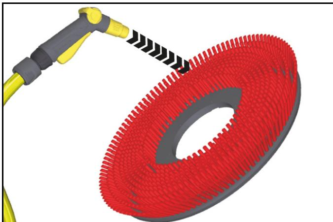
Die Bürsten, Pads usw. entnehmen und gründlich von sichtbaren Verschmutzungen befreien. Anschließend gründlich mit Wasser spülen, trocknen lassen und gegebenenfalls anschließend desinfizieren.
