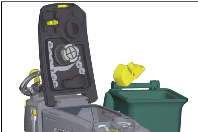
Den Schmutzwassertank und die dazugehörigen Komponenten wie Grobschmutzkorb, Schwimmer, Tankspülsystem usw. von sichtbaren Verschmutzungen befreien. Anschließend gründlich mit Wasser spülen, trocknen lassen und gegebenenfalls anschließend desinfizieren.
