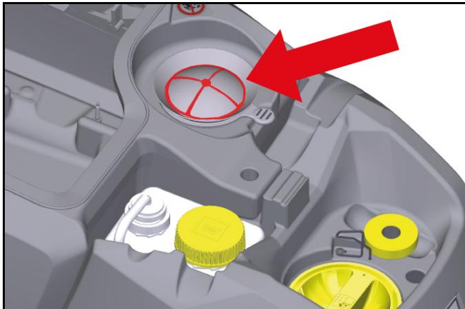
Den Turbinenfilter auf Verschmutzung prüfen und bei Bedarf reinigen.
