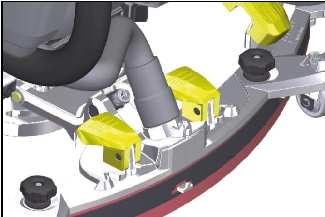
Den Saugschlauch abnehmen und auf Verunreinigungen überprüfen. Falls erforderlich, sollte der Saugschlauch gründlich gereinigt und gegebenenfalls anschließend desinfiziert werden.
