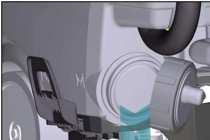
Der Frischwassertank sollte nach jeder Verwendung restentleert werden. Um das Trocknen zu beschleunigen, können der Frischwassertankdeckel und der Ablass geöffnet bleiben. Zudem ist es wichtig, den Frischwasserfilter regelmäßig auf Verschmutzungen zu überprüfen und bei Bedarf zu reinigen.
