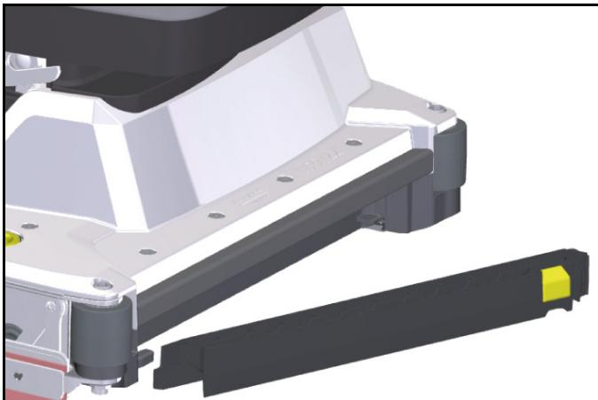
Die Wasserverteilleiste entnehmen und sichtbare Verschmutzungen entfernen. Anschließend gründlich mit Wasser spülen, trocknen lassen und gegebenenfalls anschließend desinfizieren.
