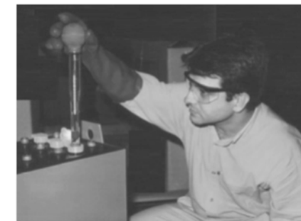
Medição de densidade do Eletrólito
