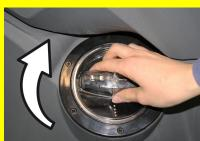
A Deckel des Frischwassertanks öffnen. Frischwasser (maximal 60 °C) einfüllen. Ausreichend Raum für das Reinigungsmittel freilassen.
