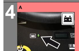
Batterieanzeige blinkt A Batterie laden.
