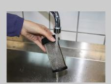
A Sieb im Schmutzwassertank prüfen und reinigen.
