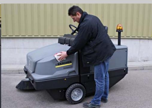
A Staubfilter prüfen und gegebenenfalls Filterkasten reinigen.
