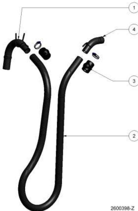
12.22.1 Ersatzteilliste Saugschlaucheinheit DN 50, alle Typen
