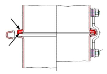
Lors de l'utilisation de joints EPDM, il suffit d'enlever la peinture des deux côtés du bordage pour chaque tuyau. Cela garantit une mise à la terre continue de la canalisation.
