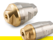
Rørrensningsdyse med Roto-Jet Den fremadrettede roterende stråle fjerner det mest stædige snavs. De tre bagudrettede stråler sikrer den nødvendige fremdrift. Varenr. 4.765-004.0 - 500 til 800 l/t ex. HD 8/18 M Varenr. 4.765-005.0 - 800 til 1.000 l/t ex. HDS 10/20-4 M
