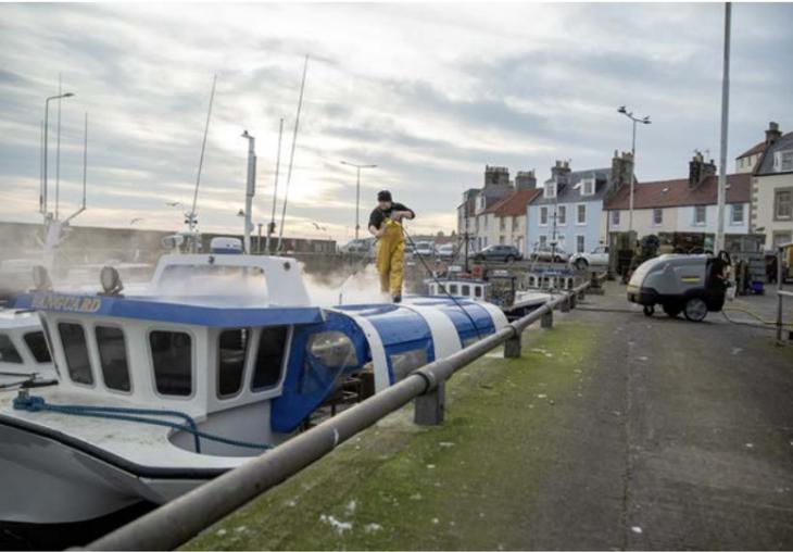
La limpiadora de alta presión de agua caliente permite eliminar la suciedad de la cubierta de forma especialmente sencilla. La barredora con acompañante deja el muelle limpio.
