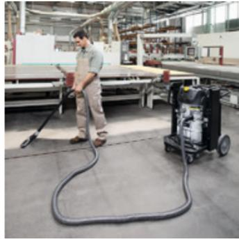
Der passende Schlauch zur jeweiligen Anwendung ist unabdingbare Voraussetzung für sicheres Saugen. Die Bandbreite reicht von Anwendungen wie dem Saugen von Mineralstaub über das Saugen abrasiven und flüssigen Saugguts wie mit Spänen versetzten Flüssigkeiten und Öl bis hin zu Metallspänen und heißer Schlacke. Bei der Auswahl sind Zubehörronnweite und Schlauchlänge zu berücksichtigen.
