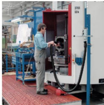
Robuste und leistungsstarke Düsen und Düsenhalter zur speziellen Verwendung mit fest installierten Handabsaugstellen bei der Maschinenreinigung.
