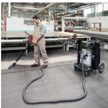
Der passende Schlauch zur jeweiligen Anwendung ist unabdingbare Voraussetzung für sicheres Saugen. Die Bandbreite reicht von Anwendungen wie dem Saugen von Mineralstaub über das Saugen abrasiven und flüssigen Saugguts wie mit Spänen versetzten Flüssigkeiten und Öl bis hin zu Metallspänen und heißer Schlacke. Bei der Auswahl sind Zubehörrönnweite und Schlauchlänge zu berücksichtigen.
