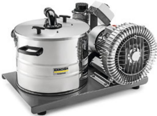
Drehstrombetriebene Beistellsauger der IVR-B-Reihe sind speziell für Einsätze unter schwierigen Platzverhältnissen konzipiert. Die kompakte Bauweise und die geringe Bauhöhe erlauben ihren Einbau auch in engen Bauräumen. Sie sind durchgehend leitfähig, eignen sich dank des Edelstahl-sammelbehälters auch zum Saugen aggressiver Saugmedien und sind darüber hinaus im Dauerbetrieb einsetzbar.
