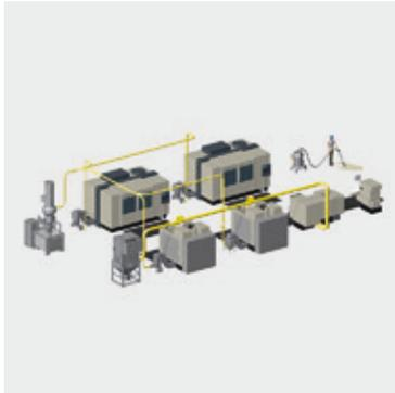
Mit speziellen Rohrleitungen für Industriesauger ist deren feste Anbindung an einen gewünschten Absaugplatz mühelos zu realisieren. Die dauerhafte Absaugung während des Arbeitsprozesses vereinfacht im Folgenden die Werkstück- und Maschinenreinigung erheblich. Auch die Anbindung mehrerer Maschinen oder Handabsaugstellen mit Verteilerstücken ist so einfach umzusetzen.
