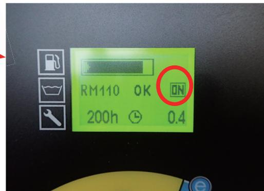
● 温度設定スイッチを希望の温度まで上げ、ディスプレイ上で “ON” になっていることを確認する。
