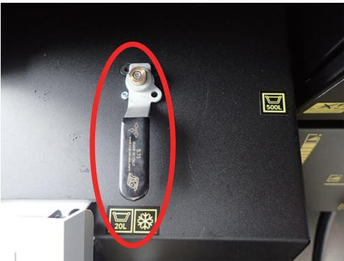
清水タンク切替レバーを20 L（凍結防止モード）側に切替える。
