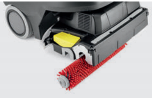
洗浄後の汚水は排水ホースで簡単廃棄 ブラシやスクイジーは工具無しで着脱可能
