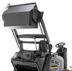
Výškové hydraulické vyprázdňovanie
