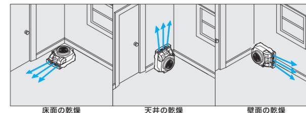
床、壁、天井など対象物に応じて3種類の置き方が選べます。対象物に直接風を当てない方式により、ムラにならず全体的な乾燥が可能です。
