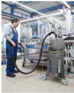
Separerer faste og flytende stoffer som kan resirkuleres
