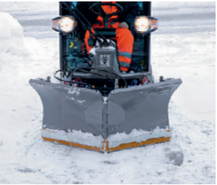
除雪作業 パワフルに除雪作業。クイック装着システムで工具不要で脱着可能です（写真は V 型スノーブレード）。
