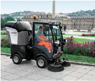
バキューム機能での清掃 スィーパーとは異なり掃除機と同様に吸引するバキュームファン型で、缶やペットボトルでも強力にゴミを吸い集めます。
