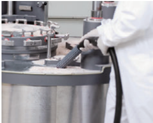
ゴム製ノズル ゴム製なので吸引する機械や機材に傷をつけず吸引できます。
