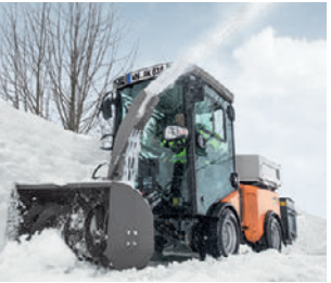
除雪作業 わずかな時間でスィーパーアタッチメントから除雪アタッチメントへの交換が可能です。
