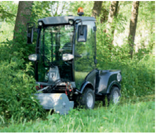
ガーデンメンテナンス（草刈り作業） 前面のサイドブラシ部分は取り替えが可能。草刈り用や除雪用など豊富なアタッチメントが利用できます。
