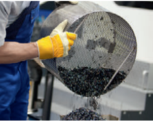
金属屑と切削油の分別が容易 ＜IVR-L モデル＞
