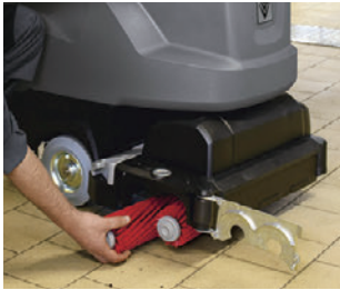
ブラシ交換に工具は不要 工具不要でブラシやスクイジーが交換可能
