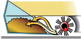
メインブラシが路面のゴミを効率良くダストコンテナに掃き込みます。
