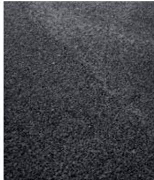
Hohlraumfreies, dichtes Gemisch aus Füllern wie z.B. Steinmehl, Sand, Splitt oder Kies und Bitumen. Bei Bitumen handelt es sich um eine schwerflüchtige, dunkel gefärbte Substanz aus verschiedenartigen organischen Stoffen, die aus der Erdöldestillation gewonnen werden.
