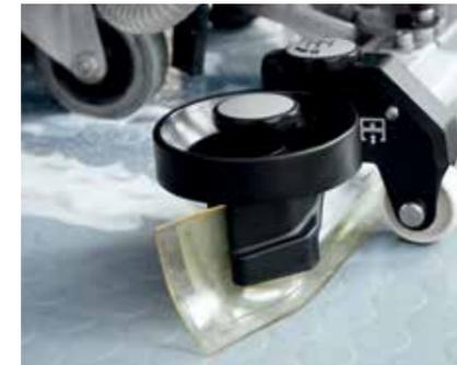
Mit der Scheuersaugmaschine mit viel Wasser (Reinigungsmittelzufuhr abschalten) und mit Absaugung den Streifenbereich großräumig abfahren.
