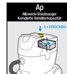
Die halbautomatische Filterabreinigung „ApClean“
