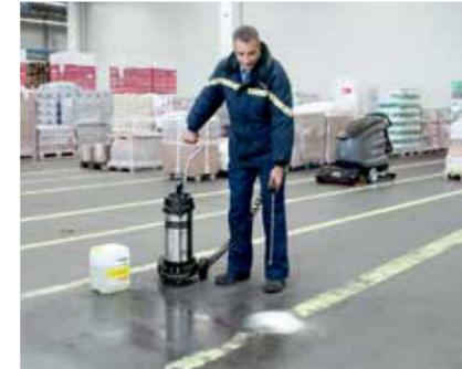
Reinigungsmittel RM 776 mit einer Sprühflasche pur auf den verschmutzten Streifen aufbringen und maximal 10 Minuten einwirken lassen.
