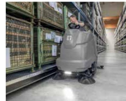
Anschließend mit einer Scheuersaugmaschine 2 bis 4 mal ohne Wasser und ohne Absaugung über den Streifen fahren.
