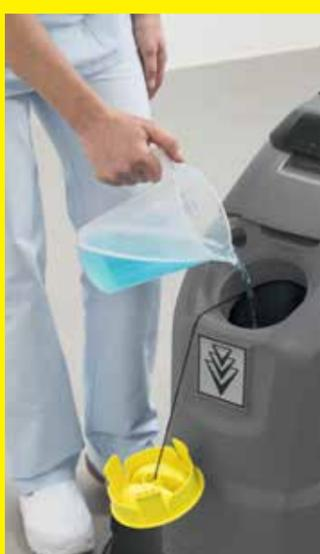
Neben technischen Hilfsmitteln ist die klassische Dosierung von Hand weit verbreitet, insbesondere wenn nur eine Maschine zum Einsatz kommt. Die nebenan stehende Dosiertabelle hilft, die Dosierung exakt vorzunehmen.
