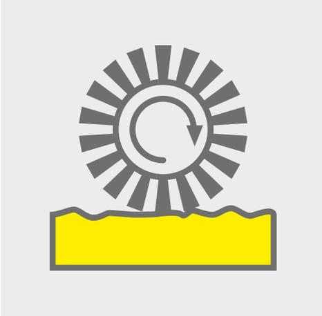
Die Mechanik wird bei der Bodenreinigung durch Bürsten oder Pads übertragen. Je nach Verschmutzung, Untergrund und Reinigungsart kann der Grad der Abrasivität durch die Wahl unterschiedlicher Bürsten und Pads gesteuert werden. Des Weiteren haben auch die Drehzahl und der Anpressdruck von Bürste/Pad einen Einfluss auf die Mechanik.
