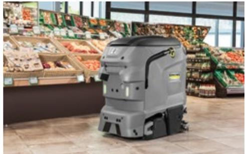
Scheuersaugmaschinen sind mit einem Bürstenkopf und einer Absaugung ausgestattet. Dies ermöglicht eine gründliche und effiziente Reinigung und einen sofort trockenen Boden. Scheuersaugmaschinen sind mit oder ohne Fahrtrieb in verschiedenen Varianten erhältlich.
