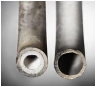
Die Flüssigenthärereinrichtung DGT ist eine Vorrichtung, die dem zu schnellen Verkalken der wasserführenden Teile, insbesondere der Heizschlange, vorbeugt. Ein Mehrkomponentenprodukt auf der Basis temperaturbeständiger, organischer und anorganischer Salze wird je nach Härtegrad des Wassers tröpfchenweise in den Schwimmerkasten eingebracht und schützt wasserführende Teile vor Korrosion.
