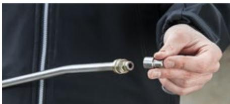
**!** **Anti-Twist** verhindert Verdrehen des Schlauches an der Pistole.
