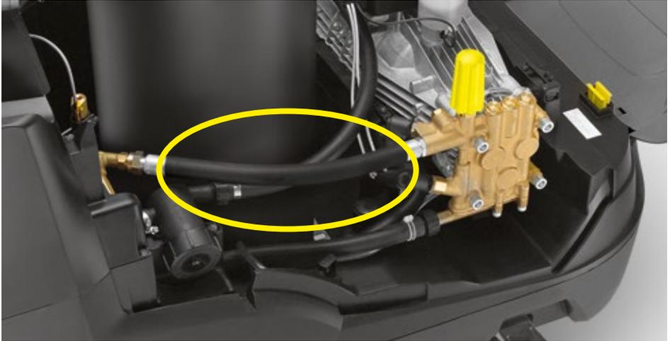
Ein spezieller Hochdruckschlauch zwischen dem Sicherheitsblock und der Hochdruckpumpe eliminiert/kompensiert die auftretenden Schwingungen im Hochdrucksystem um den Faktor 2,5.
