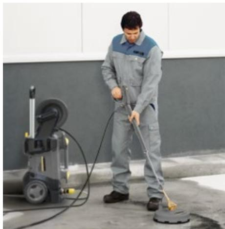
Flächenreiniger ermöglichen eine bis zu zehn Mal höhere Flächenleistung als ein herkömmlicher Hochdruckstrahl bei der Reinigung von Hartböden und Wänden. Besonders komfortabel bei der Verwendung eines Flächenreinigers ist der Schutz vor Spritzwasser. Zudem kann ein sehr gleichmäßiges Reinigungsergebnis erreicht werden, da stetig derselbe Abstand eingehalten wird.
