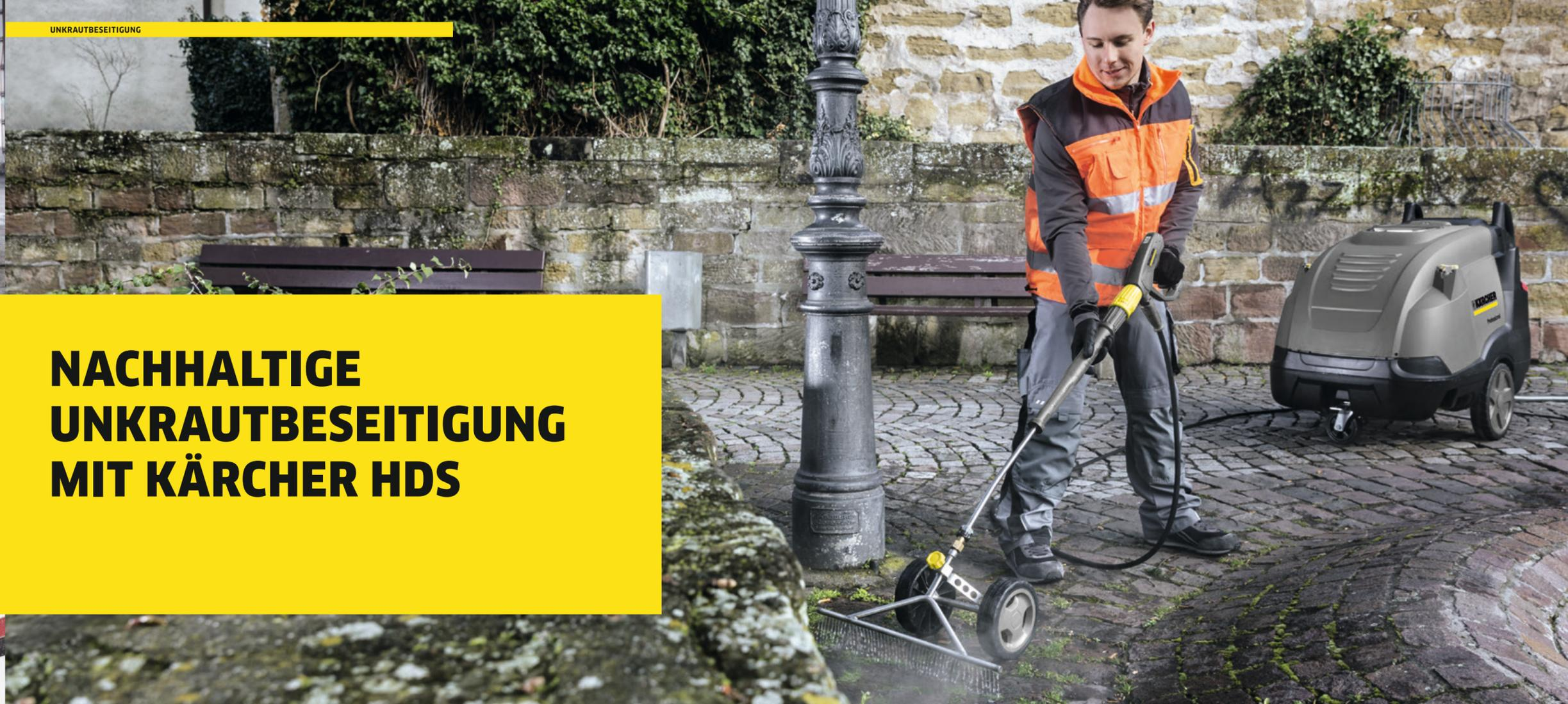
Heißwasser-Hochdruckreiniger können die Wasserzulauftemperatur von ca. 12°C auf bis zu 155°C erhöhen. Dies ermöglicht eine Reduzierung des Arbeitsdrucks, des Zeiteinsatzes sowie der Menge einzusetzender Reinigungsmittel.
