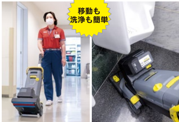
写真1 資機材庫から現場までの持ち運びが楽で、右の写真のように小便器下のわずかな隙間にもマシンを通すことができる
