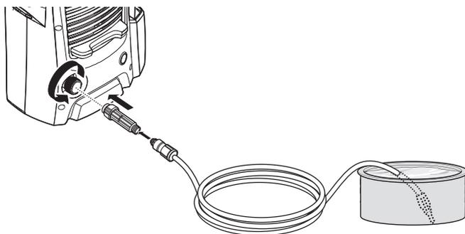
ため水を利用して高圧洗浄機を使用する場合は、まず「呼び水」を行います。呼び水を行う事で本体内部や自吸用ホース内の空気が抜け、高圧洗浄機に負担をかけずに使用することができます。
