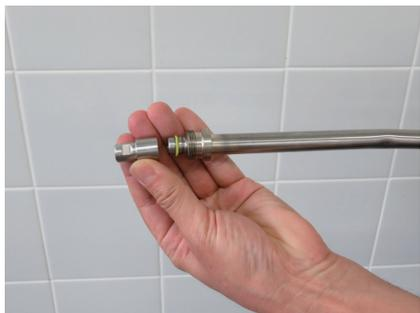
ノズルを洗剤散布用の低圧ノズルに交換してください（口径の大きい方）。
