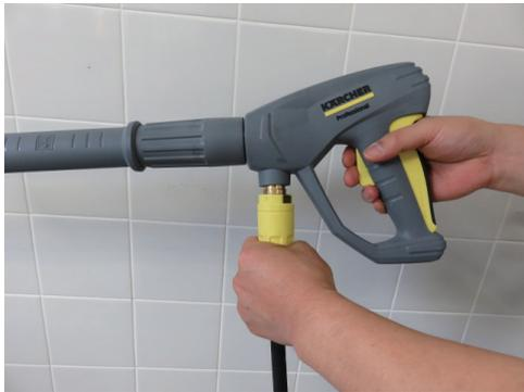
2. 高圧ホース端部のナットを止まるまで回してください。約1.5回転で固定します。
