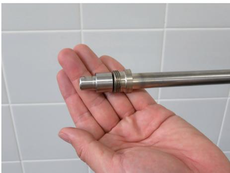
ノズルチップの側面切欠き位置により高圧広角水流の向きが変わります。
