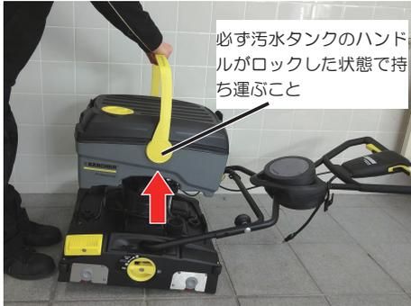
1. ハンドルを倒して汚水タンクのハンドルを引き上げてロックし、タンクを持ち上げます。
