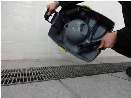
3. 汚水タンクの汚水を排水後、清水で汚水タンク内部を洗浄し、洗浄水タンクを戻してロックします。汚水タンクを本体に戻します。
