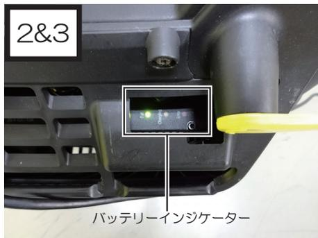
1. 本体背面の充電器用電源ケーブルをケーブルフックから外し、電源プラグをコンセントに差し込みます。
