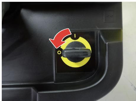
1. 洗浄水スイッチがONになっている場合はスイッチを押してOFFにします。
