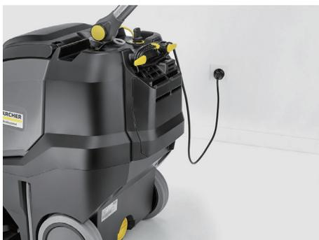
充電器用電源コードの電源プラグをコンセントに差し込み、バッテリーを充電します。
