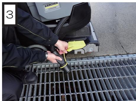
1. 本体を排水設備のある場所まで移動し、汚水排水ホースを汚水タンクから外します。
