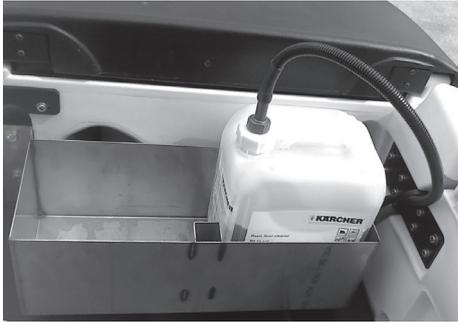
洗浄剤タンクを搭載し吸引パイプを取り付けてください。
