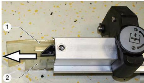
前後のスクイジーゴムを引き抜き、上下を入れ替えるまたは新しいスクイジーゴムを挿入してください。
