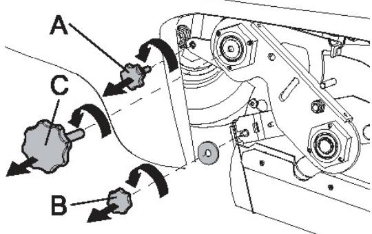
アーム固定ボルト・フラップ固定ナット・スイングアーム固定ナットを取り外してください。
