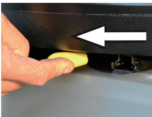
シート前方下部の黄色のレバーを引き上げシートを前後に移動し最適なポジションに調整してください。
