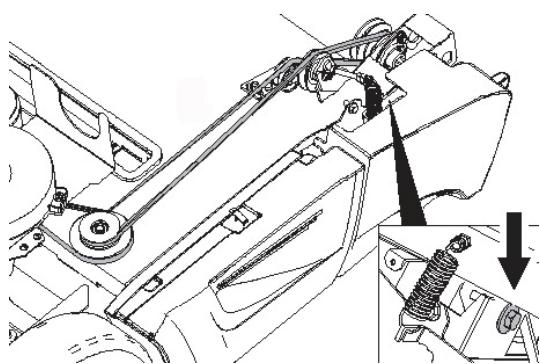
ダストフィルターコンテナ下部のブラシ駆動ベルト及びプーリーに損傷、磨耗がないか確認してください。
