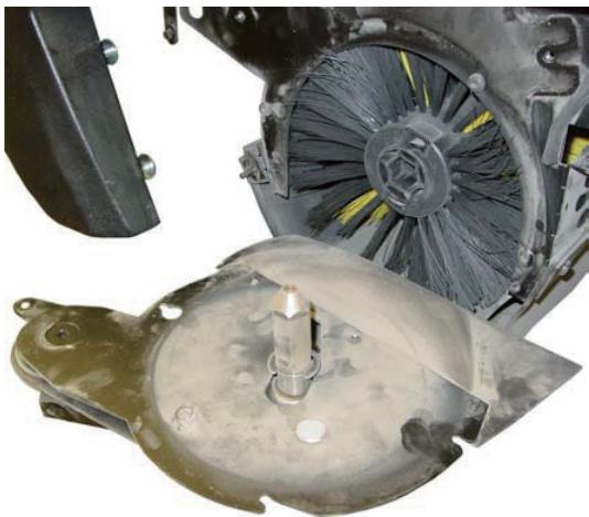
側面カバーセットを引き抜きます。
