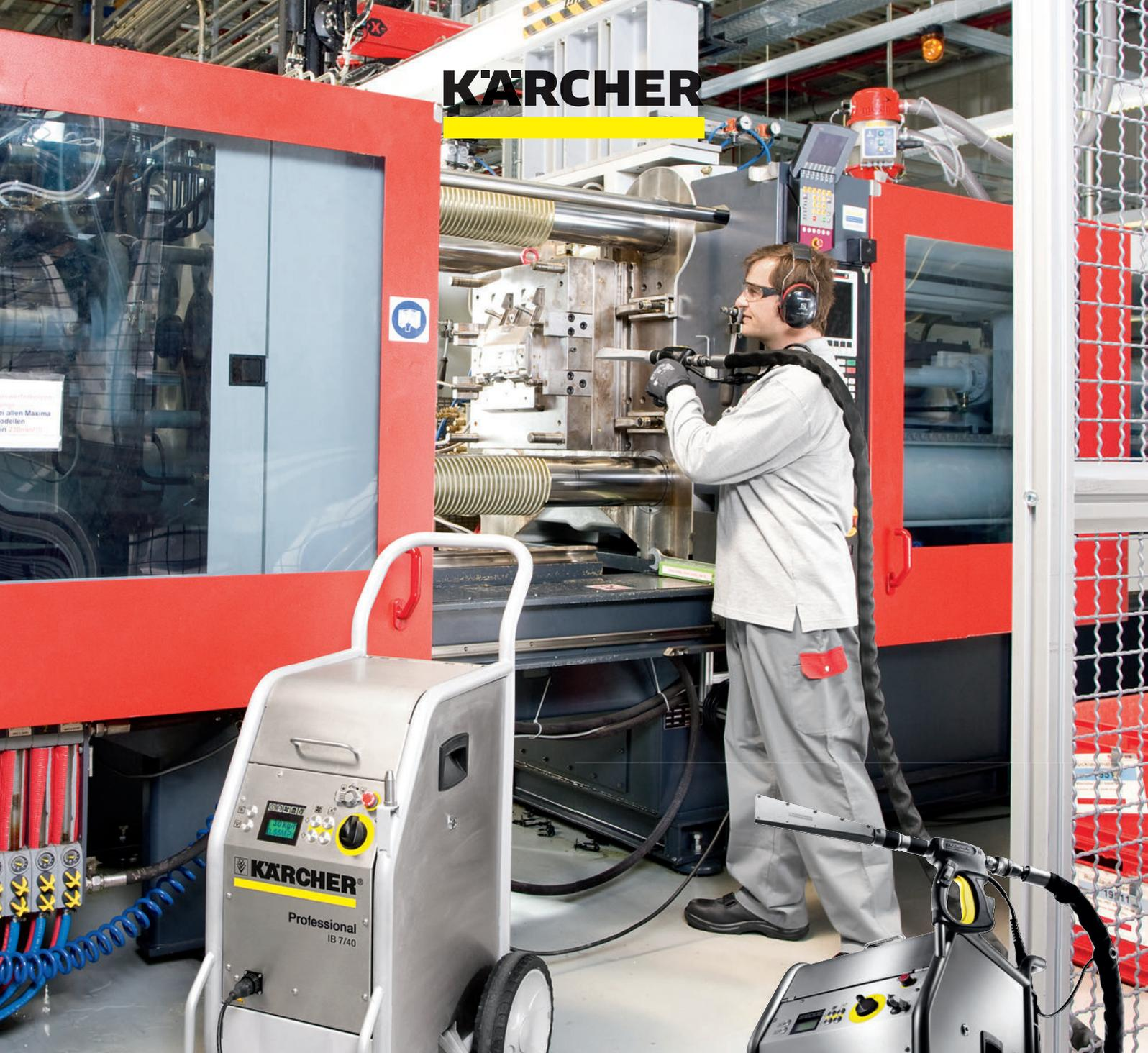
・射出成形機の金型を取り外さずに直接洗浄することで、洗浄時間を大幅に短縮し、生産のダウンタイム削減に貢献します。
