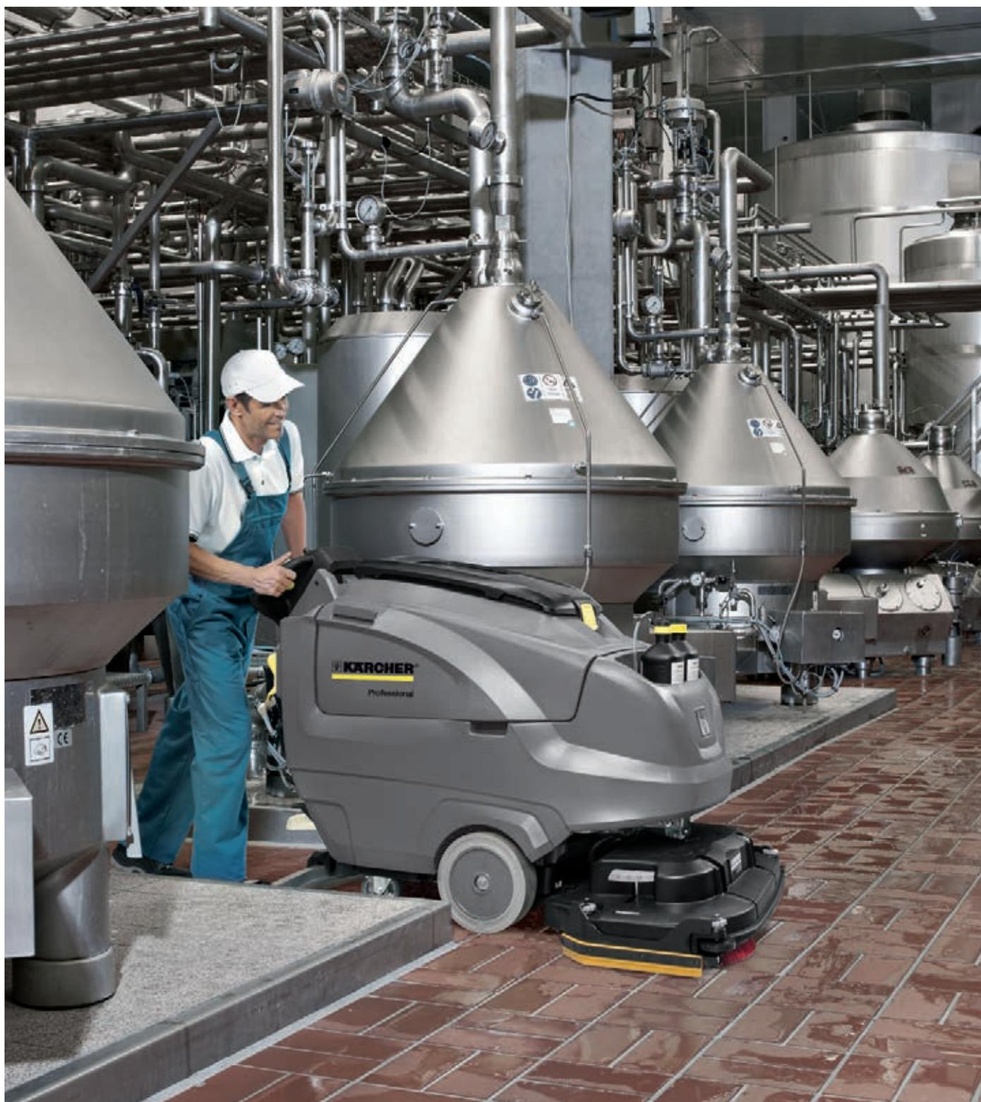
Применение полумоечной техники вместо ручного инвентаря не только упрощает и ускоряет уборку, но и улучшает ее результаты – в частности, за счет верного выбора и стабильного сохранения таких технологических параметров, как давление прижима щеток, расход воды и чистящих средств.
