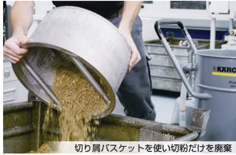
切り屑バスケットを使い切粉だけを廃棄
