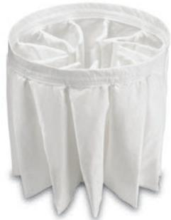
16個のポケットがフィルター面積2.2m<sup>2</sup>を実現。フィルターの目詰まりによるダウンタイムを削減します。また、ちり落とし機能でポケット一つ一つを掻くことで、ちり落とし効果を高め、フィルターのメンテナンス時間を削減します。
