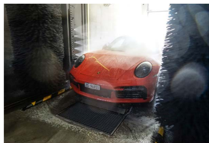
Sie hat eine intelligente Seitenbürste, die in acht einzelne Segmente unterteilt ist.
