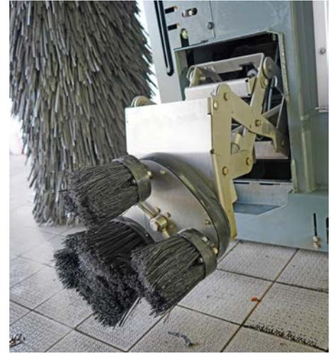
Damit auch Sportfelgen optimal gewaschen werden, verfügt die Kärcher-Portalanlage dank Scherenmechanik über eine präzise Höhenanpassung und wie bei einer elektrischen Zahnbürste elliptisch rotierende Einzelbürsten.
