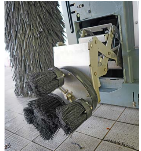
Pour que des jantes sport puissent aussi être lavées, le portique Kärcher dispose d'un système précis d'ajustement de la hauteur grâce à un mécanisme de cisailles et de brosses individuelles décrivant des ellipses, comme sur une brosse à dents électrique.
