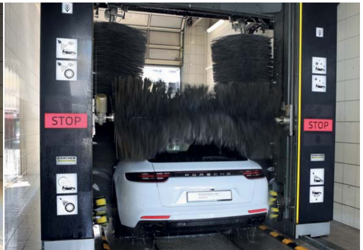
Überzeugende Innovation: Die intelligenten segmentierten Seitenbürsten passen sich der Fahrzeugkontur an und ermöglichen eine effizientere Autowäsche.
