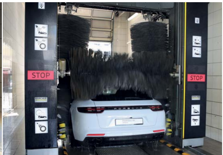
Une innovation séduisante : les brosses latérales segmentées intelligentes épousent les contours du véhicule, pour un lavage plus efficace.
