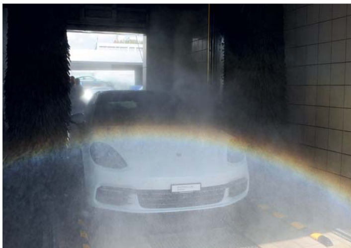
Une innovation séduisante : les brosses latérales segmentées intelligentes épousent les contours du véhicule, pour un lavage plus efficace.
