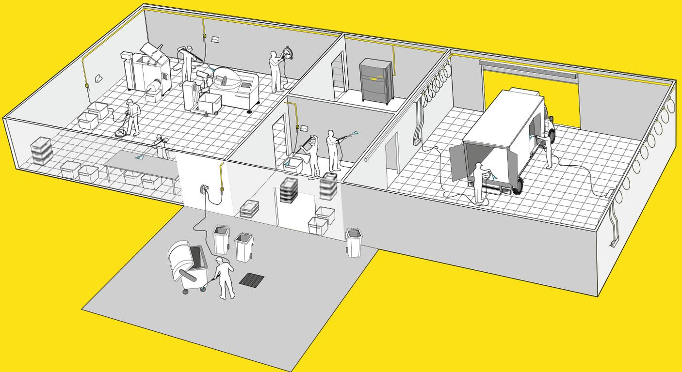
Stationäre Hochdruckreinigung ist die perfekte Lösung, wenn regelmäßig große Reinigungsleistung gebraucht wird, für mehrere Verbraucher in unterschiedlichen Einsatzbereichen oder kontinuierlich hohen Bedarf. Von einer zentralen Versorgungseinheit wird Hochdruckwasser über ein Rohrleitungssystem zu fest installierten Entnahmestellen geführt und steht dort bedarfsgerecht zur Verfügung. Universell und vielseitig einsetzbar und dabei effizient, sicher und wirtschaftlich.
