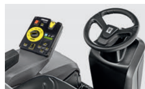
シートに着座しないと電源が入らない安全設計
