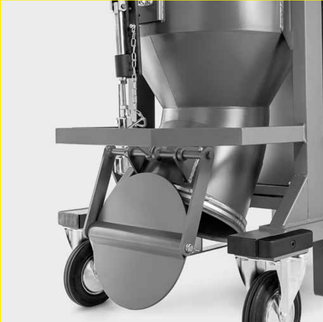
Systemer til indsamling og tømning Tømningssystem med manuel betjening. Det er også muligt at få en variant med automatisk tømningssluge, der fungerer vha. tyngdekraften. Den stationære version uden mobilt chassis kan også implementeres med kontinuerlig tømning med dobbeltkammer-lås eller rotérbar ventil.
