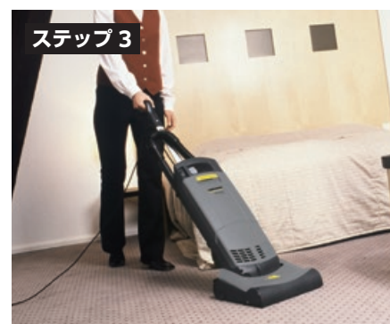
アップライト式クリーナーで、乾燥後のカーペットに残っている結晶化した汚れを除去
