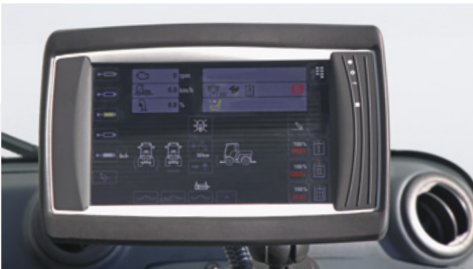
Touch-Display zur Bedienung sämtlicher Hydraulikfunktionen
